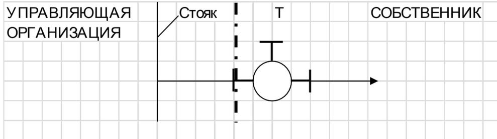
2.3. По системе водоотведения: точка присоединения отводящей трубы системы водоотведения Помещения к тройнику транзитного стояка общей домовой системы водоотведения. Тройник транзитного канализационного стояка и сам стояк обслуживает Управляющая компания, остальное оборудование Собственник. (схема № 3)
