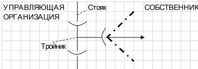
2.4. По системе теплоснабжения: первые точки присоединения подводящих и отходящих труб системы теплоснабжения Помещения к системе теплоснабжения Многоквартирного дома. Транзитные стояки системы теплоснабжения дома, подводящие и отходящие от них трубы до точки присоединения обслуживает Управляющая компания, остальное оборудование, в том числе радиатор отопления, Собственник. (Схема № 4)
